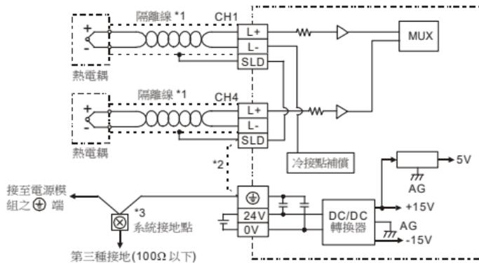
註1：使用於類比輸入的配線應採用 J, K, R, S, T 型熱電耦溫度感測器之連接線或隔離線，且應與其他電源線或可能引起雜訊之接線分開。端子鏢絲扭力為 1.95 kg-cm ( 1.7 in-lbs )。
