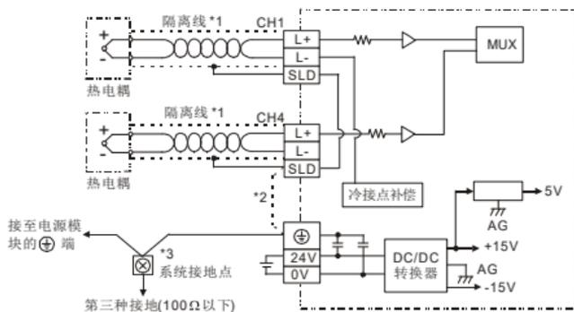
注1：使用于模拟输入的配线应采用 J, K, R, S, T 型热电偶温度传感器的连接线或隔离线，且应与其它电源线或可能引起干扰的接线分开。端子螺丝扭力为 1.95 kg·cm ( 1.7 in-lbs )
